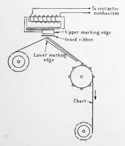
Fig. 2 .- Diagram of the impulse recorder.
